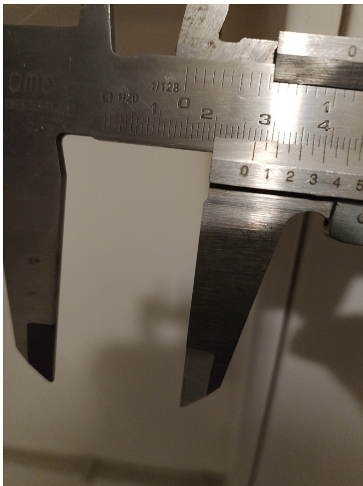
IMG_20251217_104239 // Messung des "schwarzen" Kabels
